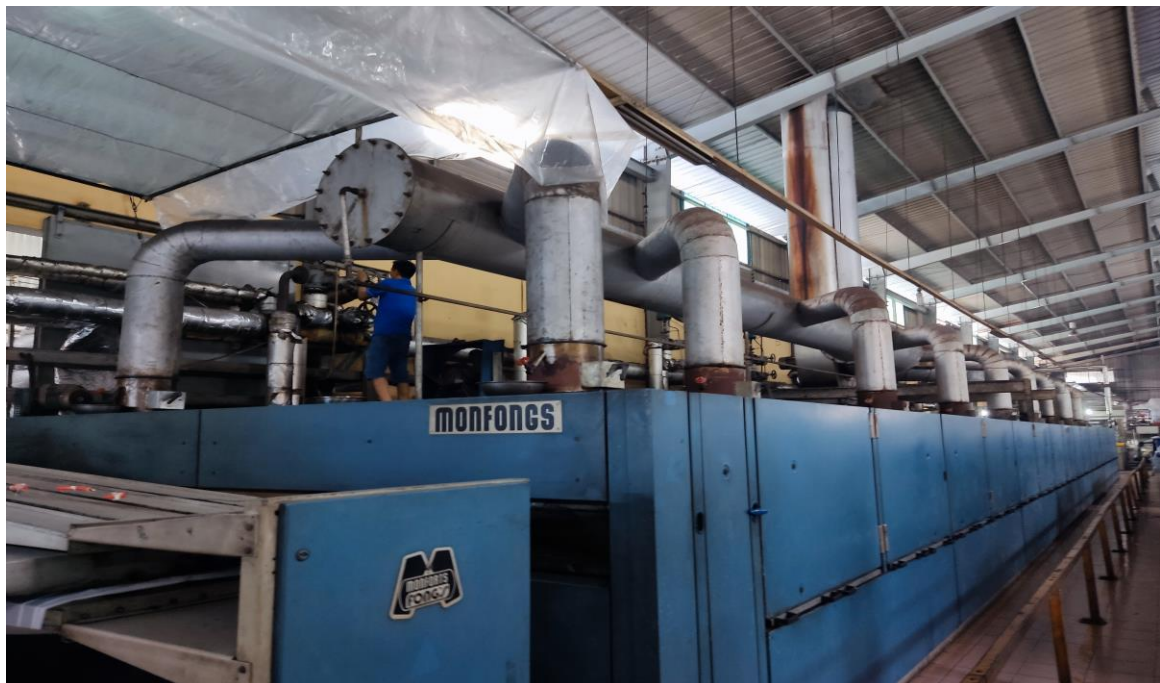
Hình 1. 9. Dây chuyền căng kim định hình tại lô J4-J5
